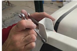
8. Retirez les butées de charge de la grille de protection de la vitre arrière.
