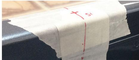
10. Utilisez du ruban de masquage et un crayon pour prolonger les lignes jusqu'à l'intérieur de la benne, afin de faciliter l'alignement ultérieur. Marquez une croix sur le rebord de benne à 15mm du bord intérieur.
