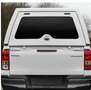
4. Vérifiez que la porte arrière est centrale par rapport au hayon arrière du véhicule.
