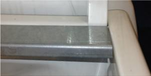
6. Positionnez la barre sur le rail avant à 1-2mm au dessus des rails latéraux. Percez des trous pilotes de 3mm à travers les trous de dégagement.
