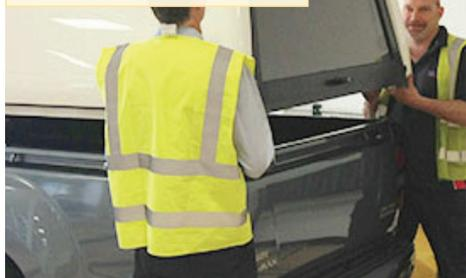
1. Soulevez le Hard Top sur la benne du véhicule en veillant à ce que ce dernier soit placé sur le support de la cloison.
