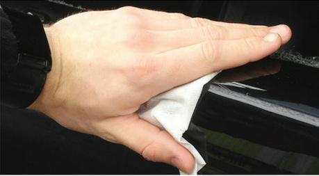
1. Nettoyez soigneusement le haut du hayon du véhicule, et appliquez une fine pulvérisation d'eau.
